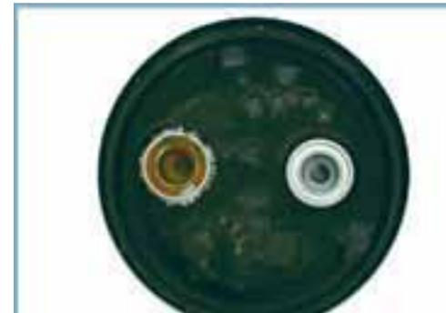
Tras dos días de experimento, el resultado empieza a verse de forma evidente, ya que los cristales de sal se han ido adheriendo al rodamiento estándar a medida que el agua se ha ido evaporando de forma natural. Por otro lado, el rodamiento con el tratamiento SALT SHIELD™ no presenta ningún cambio.
